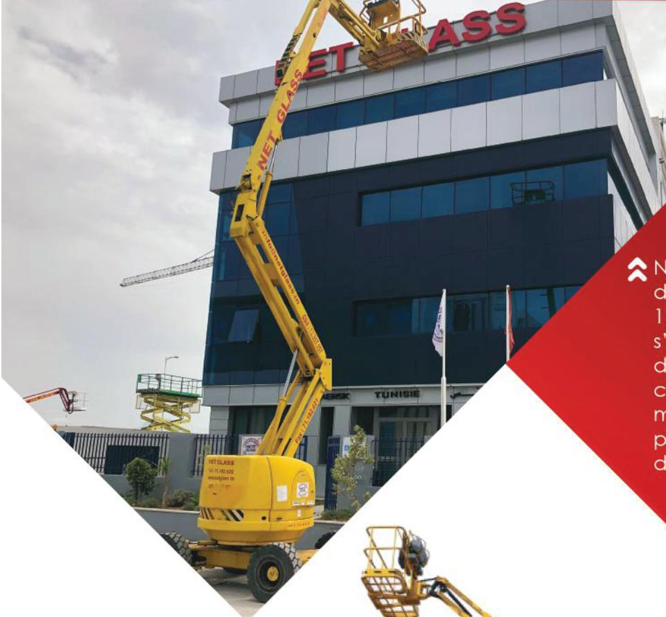
↳ Nacelle articulée 4 /4 avec un télescope diesel pour l'élévation des personnes jusqu'à 16 m de hauteur. Robuste et fiable, elle s'utilise à l'extérieur uniquement. L'utilisation de la nacelle est facile , commande de la cabine en haut pour se déplacer et manœuvrer en hauteur ainsi que du sol . pratique pour contourner les obstacles ou des déports importants.
