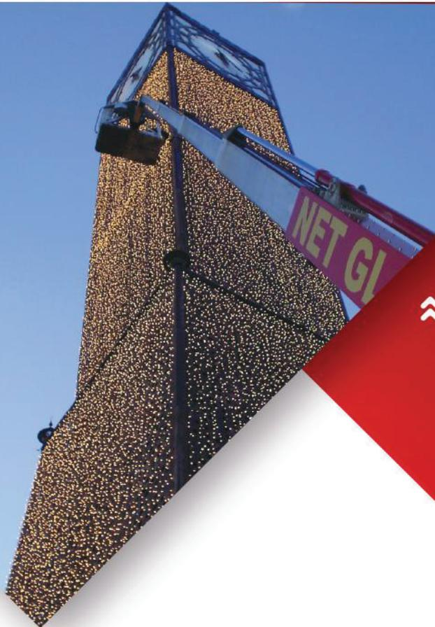
↗ la nacelle bi-énergie est équipée d'un générateur diesel fonctionnant comme un chargeur de batterie afin d'apporter une alimentation supplémentaire sur les chantiers les plus exigeants. Il est parfaitement adapté aux roulements d'équipes et offre une durée supplémentaire
