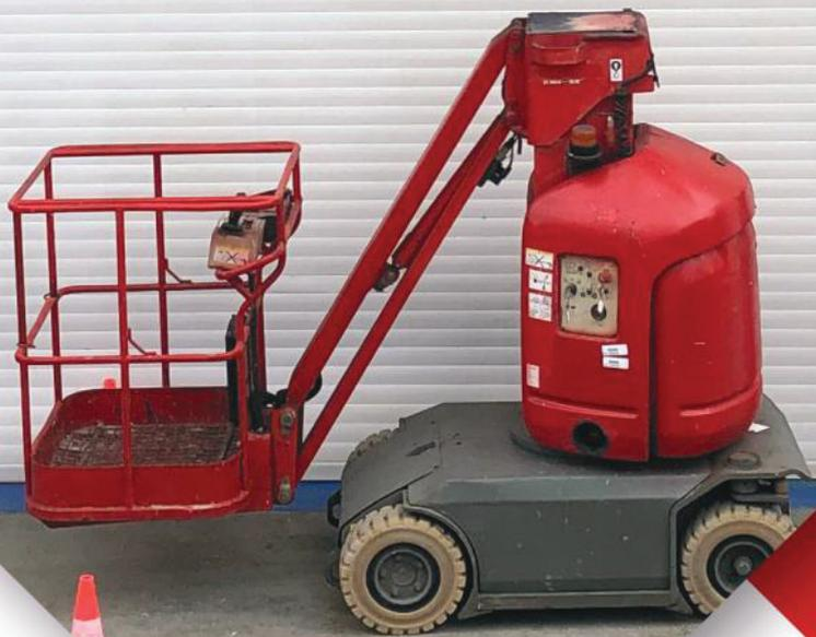
↗ ces nacelles automotrices vous permettent de travailler en toute sécurité dans de multiples applications polyvalentes. Utilisation en milieu industriel, sur surface dure et stabilisée, ne présentant pas une forte déclivité Le bras pendulaire permet le passage d'obstacles
